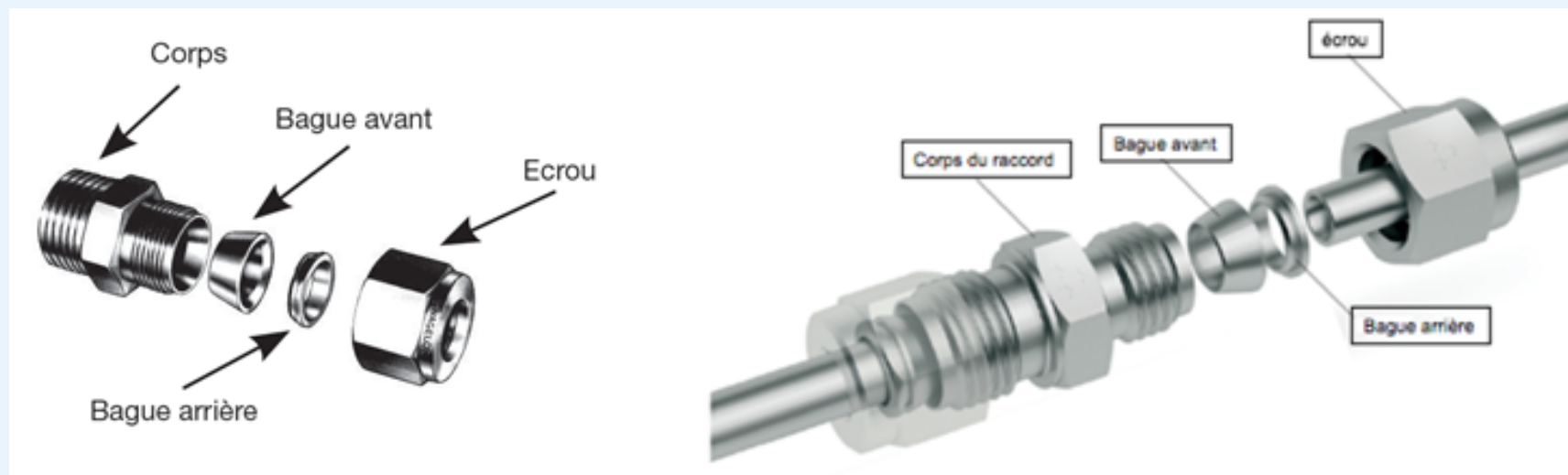
Figure 1 : Constitution d'un raccord double bague sans tube (à gauche) et avec tube (à droite)
